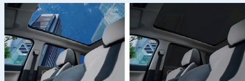
液晶調光フィルム「LC MAGIC™ ノーマルブラック」の自動車への搭載イメージ(CG) 左：電源ON時(可視光線透過率43%)、右：電源OFF時(同5%)
