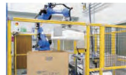
② アームロボットで袋詰めされた製品を器用に持ち上げて定数を段ボールケースに入れます。
