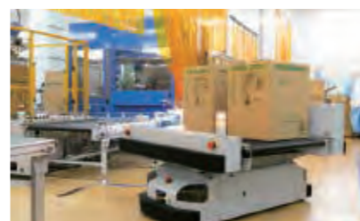
③ ケース詰めされた製品はAGV=無人搬送車に載せられてコンベアまでの短い距離を移動。
