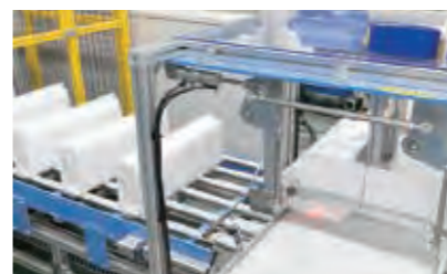
① 裁断後の製品は自動包装機でポリ袋に包み、コンベアで移動。
