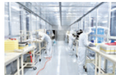
スーパークリーンルーム内部(ISOクラス1)で、貼り合わせ加工を実施
