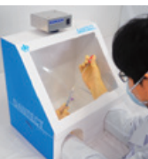
病原体検査用陰圧BOX 「DANTECT for Pt」
