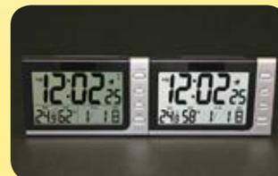
光拡散フィルムを使用した反射型液晶ディスプレイ(右側)
