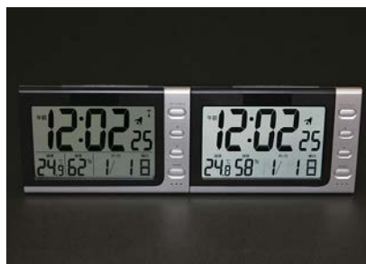
リンテックの光拡散フィルムを使用した反射型液晶ディスプレイ(右)
