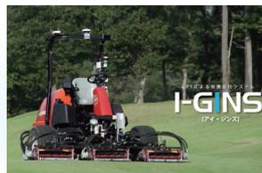
マミヤ・オーピー(株)が開発した自律走行システム「I-GINS®」(Integrated-GPS Inertial Navigation System)は、高精度のGPSと慣性航法システムを採用し位置を検出、予め作成された経路を独自のアルゴリズムで機体を誘導し、高精度で制御できるシステムです。様々な技術上の課題の解決や、導入保守メンテナンス体制の確立等を図りつつ、開発協力会社への納入を着実に進めております。
