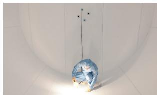
※金属製タンクの内側にふっ素樹脂加工を施し、製品状態を検査している現場の様子
