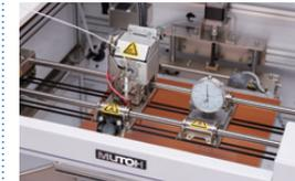
左エクストルーダには3D造形用のプリントヘッド、右エクストルーダには計測学習用のダイヤルゲージを搭載。
