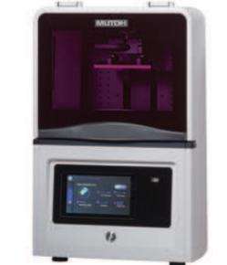
DLP方式による美しく滑らかな造形、オープンレジン方式による自在な材料選択など、さまざまなニーズに応える光造形3Dプリンタです。
