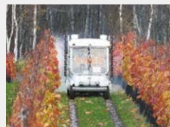
THSユニットを再利用した農業用ロボット
