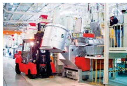
液体のままアルミを供給することで溶解工程を1回削減
