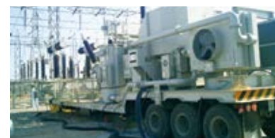
移動式変電設備イメージ((株)明電舎提供)
