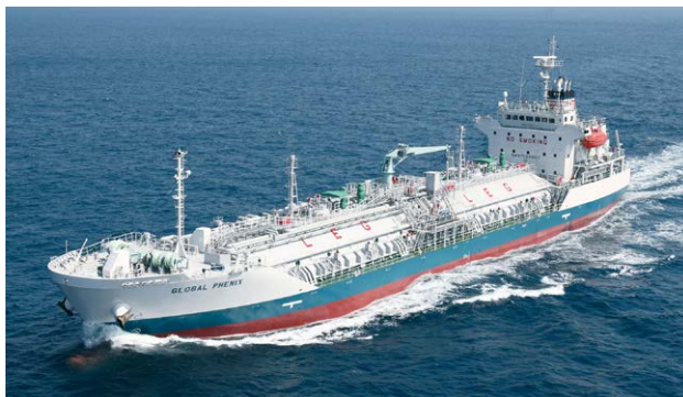
化学品トレーディング／ 当社保有のエチレン専用船 "Global Phenix"
