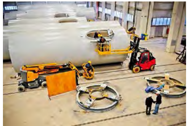
製造中の風力発電用タワー
