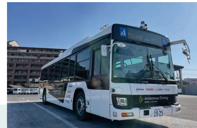
いすゞ自動車製大型自動運転バス。定員は79名
