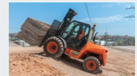
不整地走行に適したAUSA (スペイン) のタイヤ式フォークリフト
