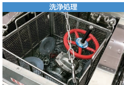
現場の要望に合わせて製品の油分を除去して出荷しています。
