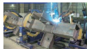
**柱大組立溶接ロボットシステム**
