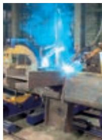
鉄骨溶接ロボットシステム
