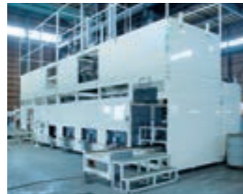
細かく砕いたチタンスクラップの脱脂、水洗い、乾燥を行う洗浄機(昭和金属(株)直江津事業所)
