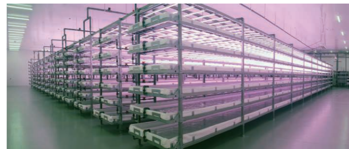
既設建物を利用した、リノベーション型大規模植物工場
