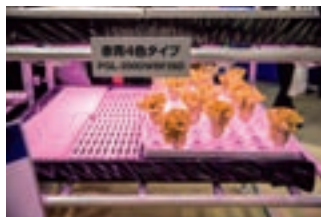
植物工場関連設備 (栽培用LED及び栽培ラック)
