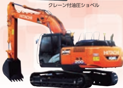
ICT仕様油圧ショベル
