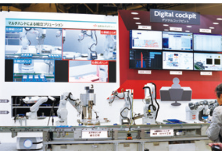
ロボットによる スマホリング製造自動化ライン
