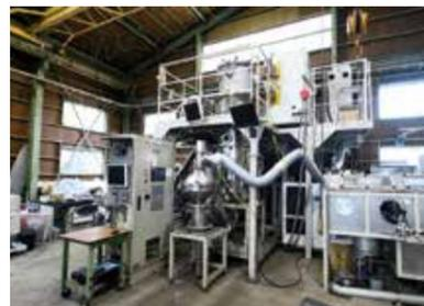
金属用3Dプリンタの素材となるガスアトマイズ粉末の製造装置。近年、需要が高まっている素材ですが、真壁技研では30年以上前から開発・製造を行っています。
