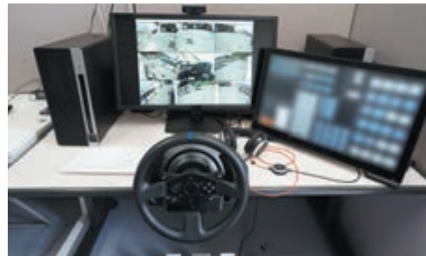
旭営業所に設置された「遠隔監視・操作システム」
