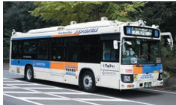
遠隔監視・操作のカメラ、スピーカー、マイク等を装備した自動運転バス
