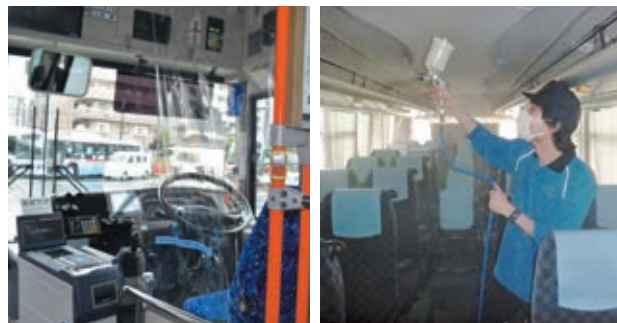
上：最前列の座席使用中止 上左：運転席付近でのビニールカーテン設置／上右：光触媒噴霧作業
