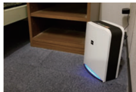
宿泊所への空間除菌消臭装置の設置
