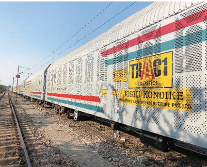
インドでの自動車輸送専用車両。1編成で小型車約300台前後の完成車を搭載可能
