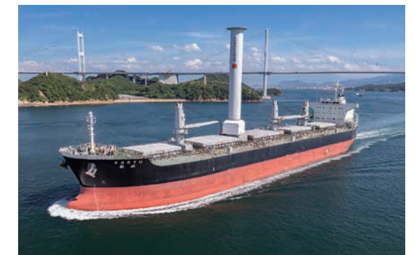
ローターセイルを装着した日本マリン(株)「KORYU」号
