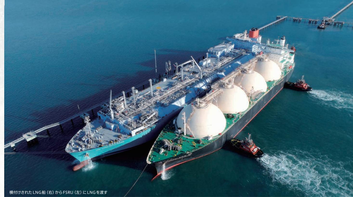
横付けされたLNG船（右）からFSRU（左）にLNGを渡す
