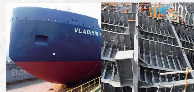
押し寄せる氷の圧力に耐えるため、船殻に強靱な砕氷補強を施した
