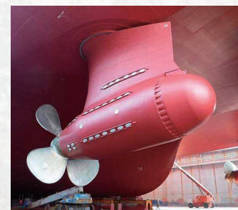
前・後進の切り替えが容易で、小回りが利くアジポッド推進システムを採用
