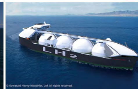
160,000m 3 型 液化水素運搬船コンセプト図 (提供：川崎重工業株式会社)
