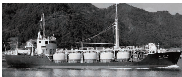
日本初の圧力式小型LPGタンカー「桃邦丸」(1960年竣工/314GT/ 565m³)
