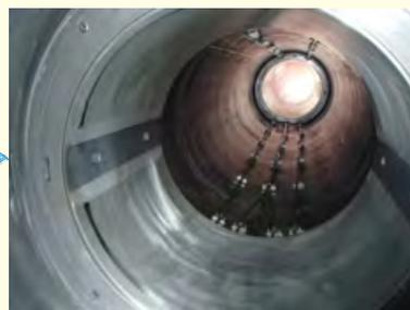
プロペラ軸を抜き、船尾管の点検
