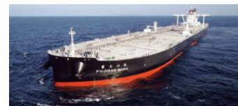
SOxスクラバー搭載VLCC 富士山丸(五代目) 312,499DWT
