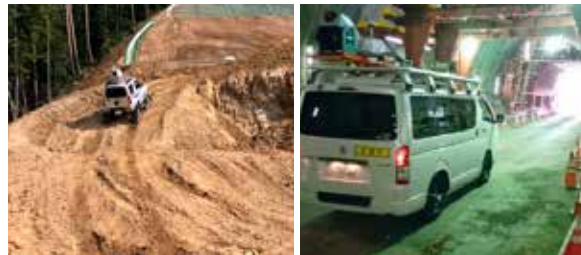
未舗装地を走行するレーザー計測システム トンネル内空のレーザー計測システム
