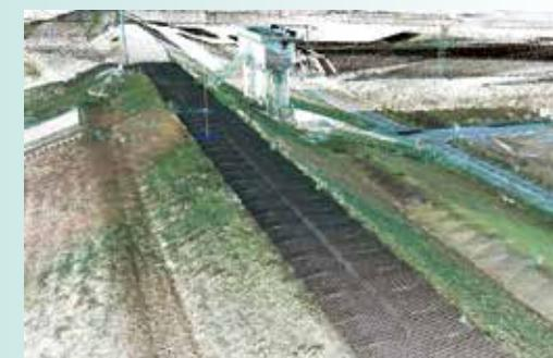
レーザースキャナーで収集した堤防の座標点群データ
