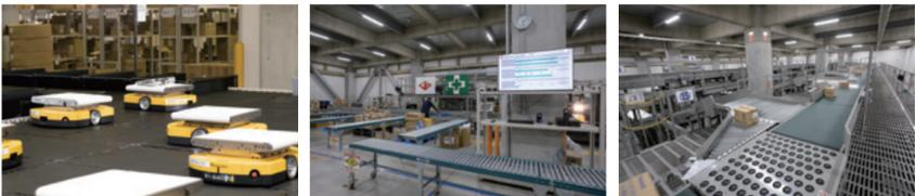
▲AGVによる仕分け作業 ▲作業進捗状況モニターシステムを使用した業務管理 ▲自動ソーターによる仕分け作業
