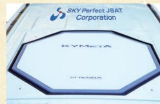
平面アンテナ(自動車の屋根に設置)
