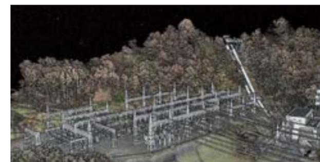
ドローンで撮影したデータから三次元モデル化した例：糖平発電所
