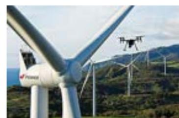
Jパワーは、これまで電力設備点検の安全性向上や作業時間・コストの削減に向け、送電線・架空地線自律撮影技術を使った送電設備点検ドローンの技術開発など、ドローン活用推進に取り組んできました。その取り組みの中で、2020年9月からKDDIと共同で、風力発電設備においてドローンのオートフライト機能（自動飛行機能）を活用したブレード（風車の翼部分）点検実証を実施し、点検時間を従来の10分の1程度に短縮することに成功しました。2021年5月以降、67基の風力発電設備を対象としたオートフライト機能を活用したドローンによるブレード点検をすべて完了し、23.3期はさらに対象を拡大して点検を実施しています。
