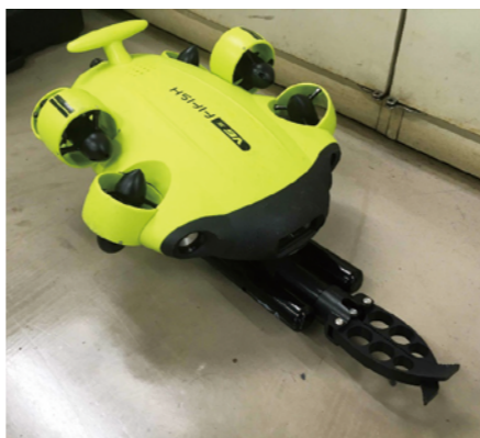
小型水中ドローン(水力発電所の保全業務に活用)
