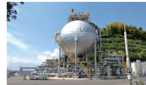
NEDO事業で進めている液化CO 2 タンクの外観 (提供：日本CCS調査株式会社)
