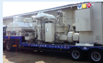
開閉装置一体型移動用変圧器
