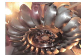
栃尾発電所ランナ（水車羽根車）
