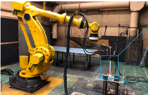
伝熱管コーティングの試験施工の様子
