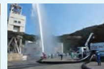
大型放水砲／大型ポンプ車
