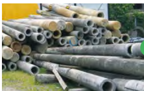
再生処理前のコンクリート柱
