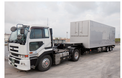
▲移動用発電設備
