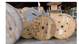
電線ドラム（木製）の 回収・再使用
