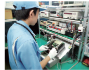
電子式電力量計の修理
