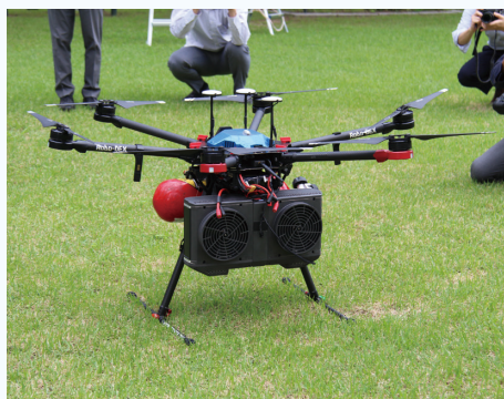
2021年6月に豪州褐炭から製造した水素を輸入し、ドローン飛行試験を行いその品質を確認
