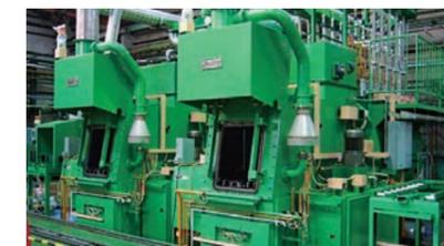
シングルエンドドラリアントチューブバーナ搭載の熱処理炉
