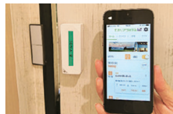
ドアの開閉に反応するセンサーとスマートフォンの通知画面
